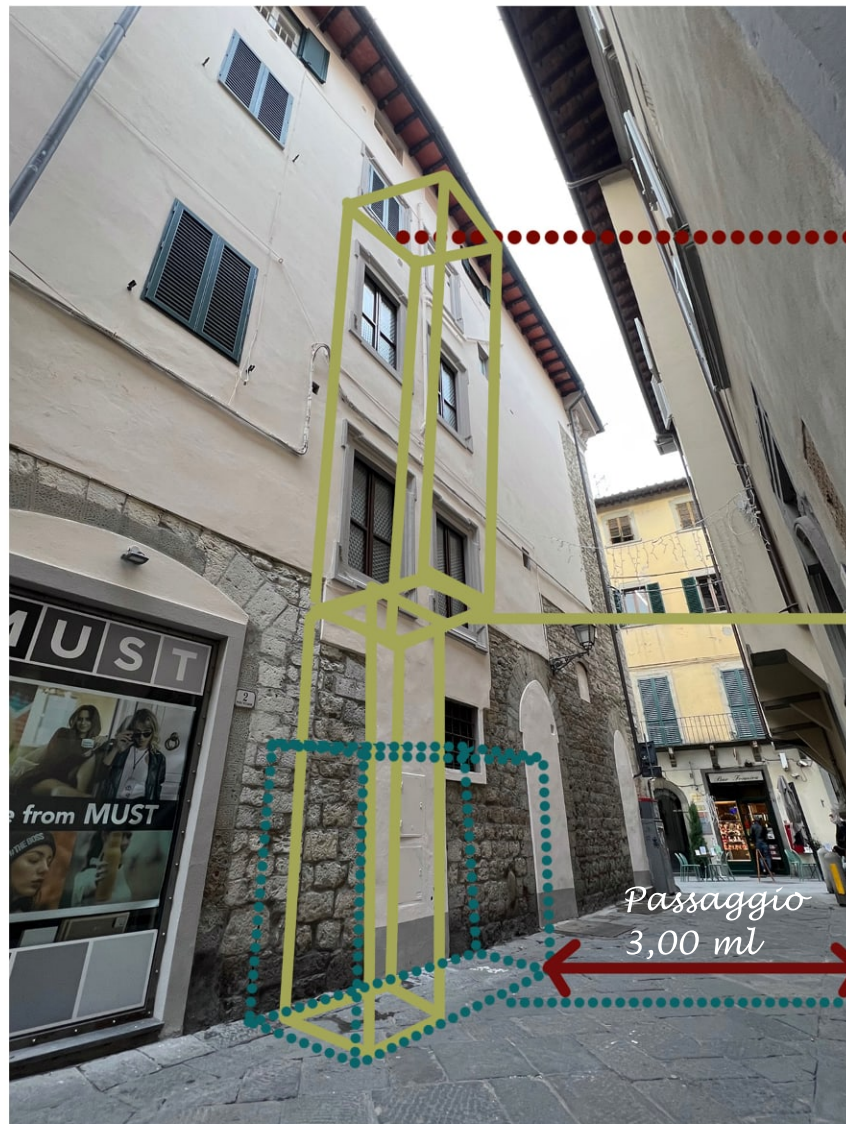
Vista della facciata da Via dell'Accademia - pressi civico 2 Schematizzazione dell'area di cantiere e della sagoma del ponte di tiro
